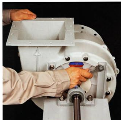
据え付け後でも吐出方向の変更が現場でラクラク OK。分解不要。作業はボルトを外すだけ。30度ピッチで自在に吐出方向が変えられます。さらに、R回転・L回転もインペラー、シャフト以外は共用部分につき、現場にて変更可能。
